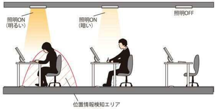
図 2. 1. 1 新しい照明制御システムの動作
