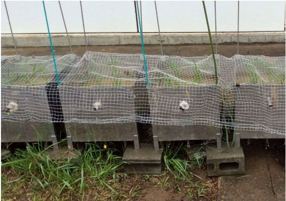
Fig. 3-1 マイクロコスム試験に使用したライシメータ装置の外観 Outlines of the paddy mesocosm experiments: Micro-paddy lysimeter
