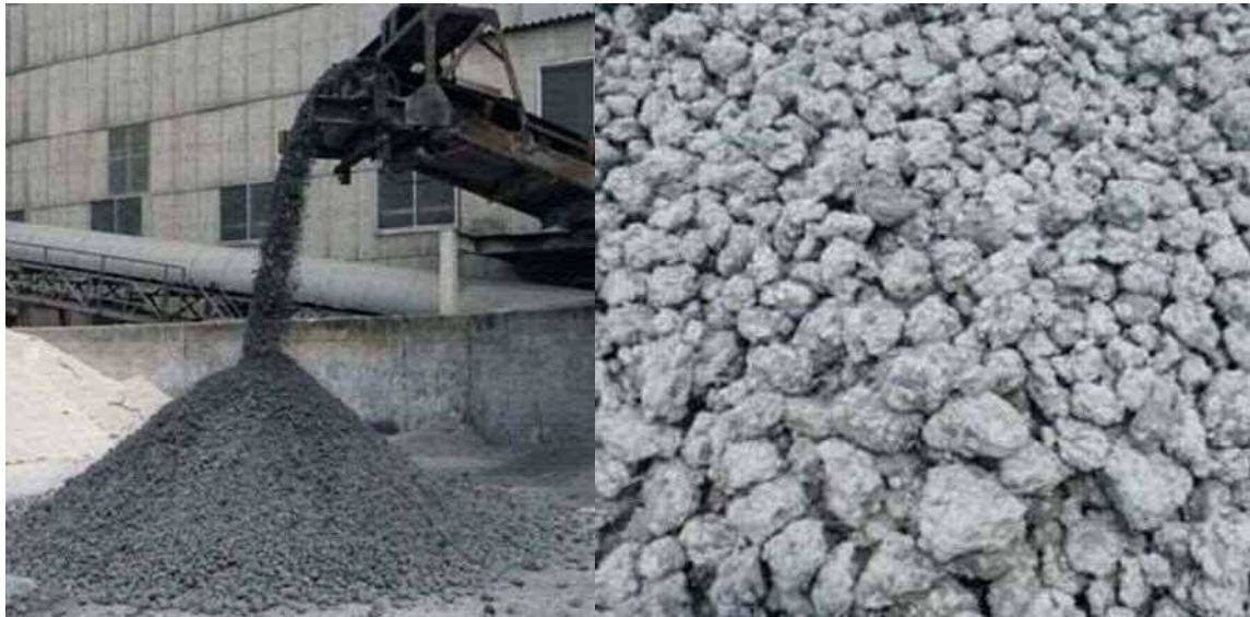
Fig. 2-3 ペーパースラッジの排出状況
