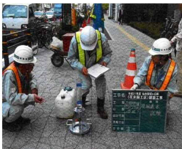
写真 (3) -23 平板舗装の透水量試験
