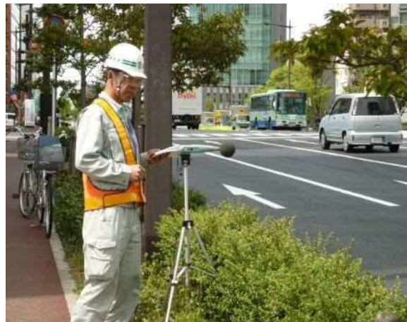
写真 (3) - 28 完成後の騒音測定
