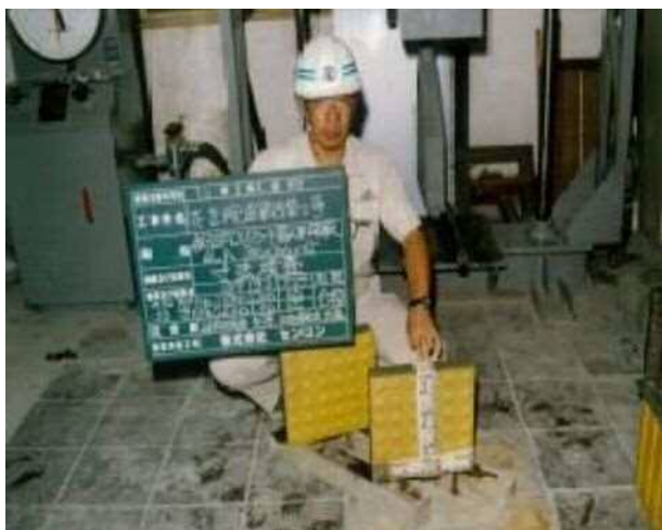
写真 (3) -25 視覚障害者ブロック寸法試験
