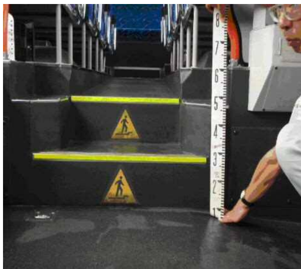
写真(4) -20 ノンステップバス内部の段差
