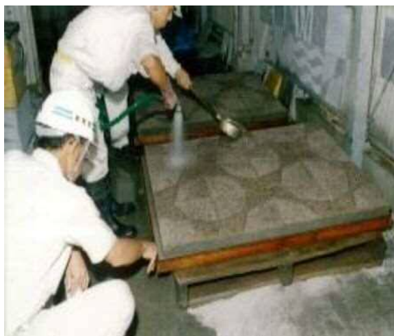
写真 (3) -21 透水性舗装の曝露試験
