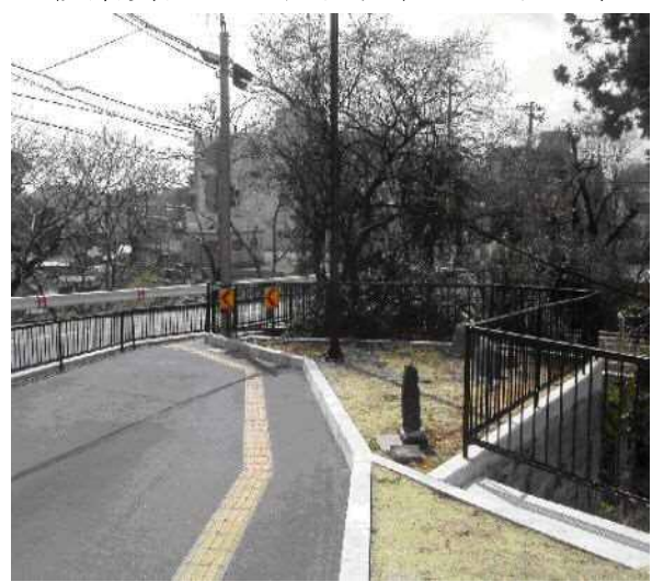
写真(4)-12 バリアフリーの歩道
